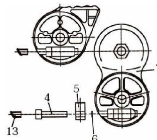
Placer le support de bras (2) sur le support (7) du kit Bras Croisé et le fixer en serrant la vis latérale M14 (8). Avant le serrage, s'assurer de la bonne mise en place de la rondelle (15) à l'intérieur du support de bras.
