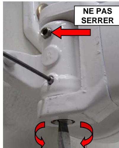
Insérer l'axe sur le support de bras, en laissant la partie fendue accessible en partie basse. Puis, utiliser un tournevis sur la fente de l'axe afin de permettre l'insertion des deux vis pointeaux.
