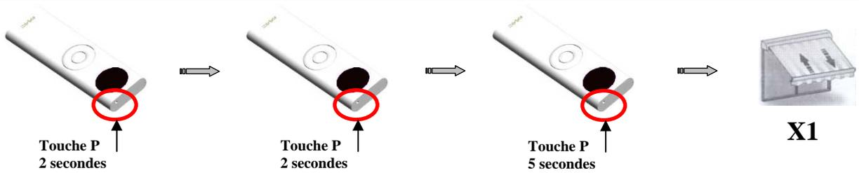
Appuyer 2 fois 2 secondes sur la touche P et une 3<sup>ème</sup> fois jusqu'à ce que le moteur effectue 1 va et vient.
