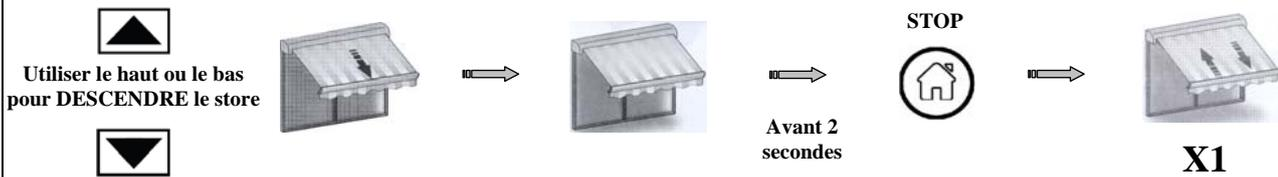
Positionner le store en fin de course BASSE et dans les 2 secondes qui suivent, maintenir la touche STOP enfoncée jusqu'à ce que le moteur effectue 2 va et vient.
