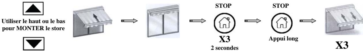
Positionner le store en fin de course HAUTE, appuyer 3 fois 2 secondes sur le bouton STOP, puis maintenir la touche STOP enfoncée jusqu'à ce que le moteur effectue 2 va et vient.
