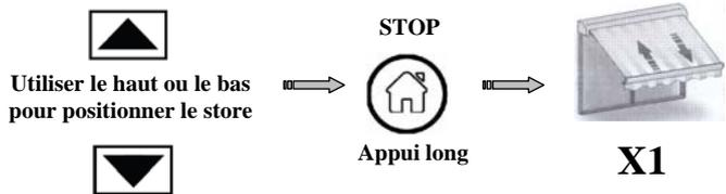
Amener le store à sa position désirée. Maintenir la touche STOP enfoncée jusqu'à ce que le moteur effectue 2 va et vient.
