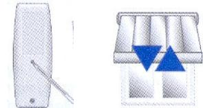
Appuyer sur le bouton derrière la télécommande. Le moteur doit effectuer une rotation.
