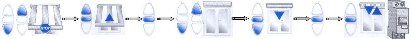
Positionner le moteur en fin de course basse et appuyer sur le bouton du haut et du milieu simultanément pendant 3s.
