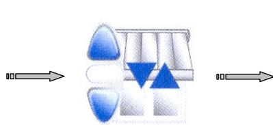
Appuyer 5s sur montée et descente. Le moteur doit effectuer une rotation.
