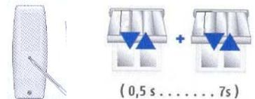
Appuyer sur le bouton derrière la télécommande pendant 7s. Le moteur doit effectuer 2 rotations.
