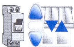
Alimenter le moteur et appuyer sur haut et bas simultanément. Le moteur doit effectuer une rotation.
