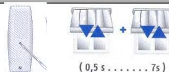
Appuyer sur le bouton derrière la télécommande pendant 7s. Le moteur doit effectuer 2 rotations.
