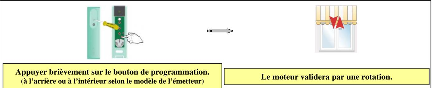
Appuyer brièvement sur le bouton de programmation. (à l'arrière ou à l'intérieur selon le modèle de l'émetteur)
