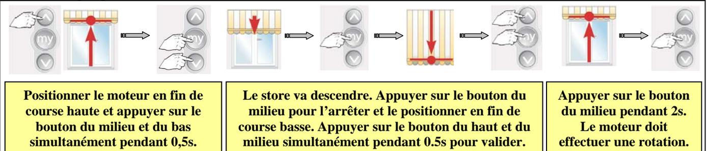
Positionner le moteur en fin de course haute et appuyer sur le bouton du milieu et du bas simultanément pendant 0,5s.
