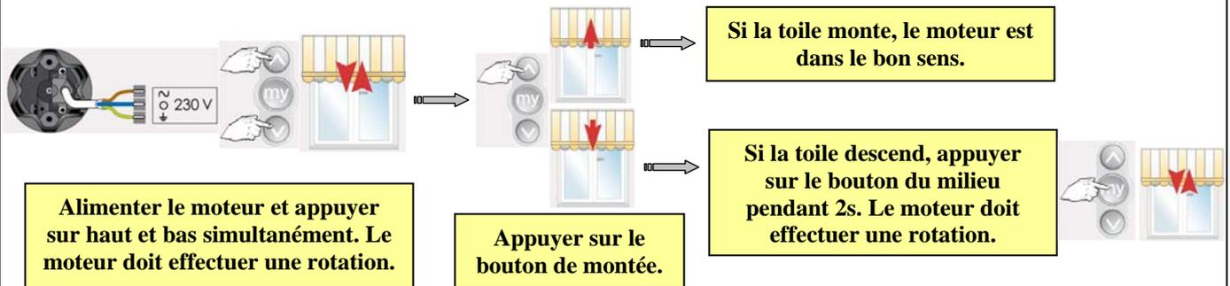
Alimenter le moteur et appuyer sur haut et bas simultanément. Le moteur doit effectuer une rotation.
